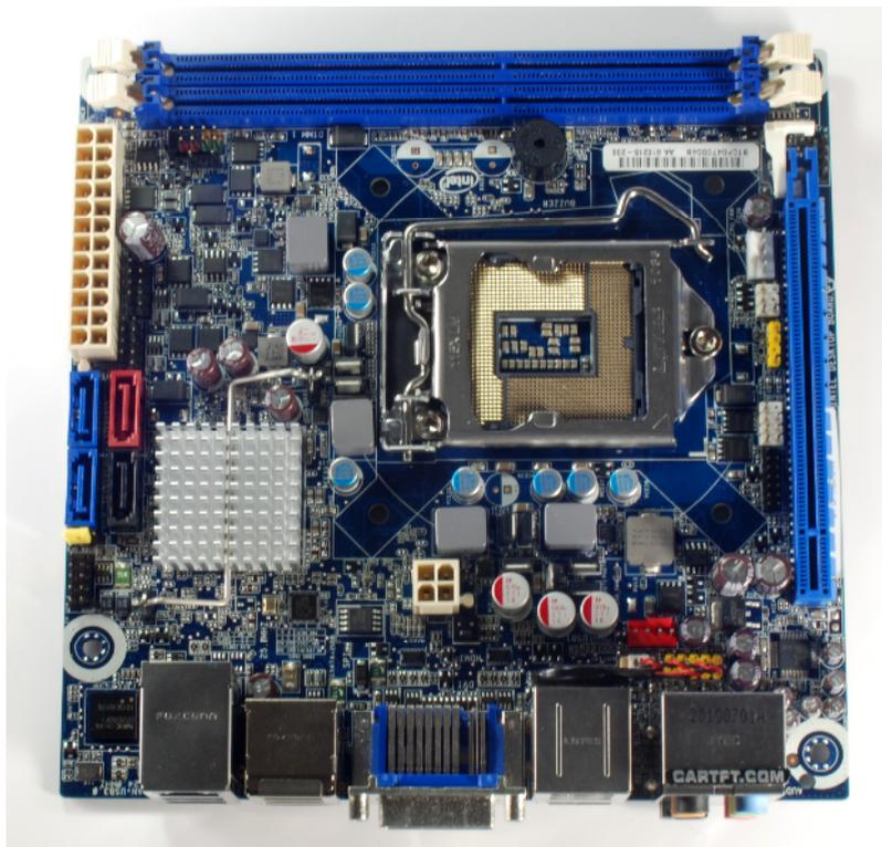
Was die Slotblende verspricht hält auch die Platine. Auch hier wurde nicht mit Anschlüssen gespart und wird jedem die Möglichkeit sich frei zu entfalten. Eines der größten Highlights sind hier aber bestimmt die 2 SATA Steckplätze mit 6,0 GB/s.
